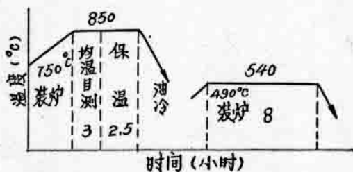
图5 40Cr叉头热处理工艺曲线
