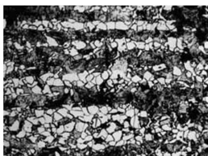
图10 试样右边的金相组织，铁素体明显呈带状分布 80×
