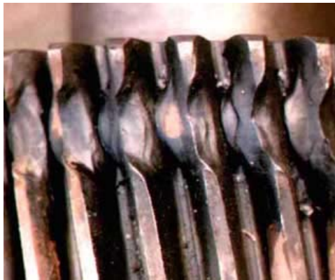
照片 1 齿轮堆塌情况（局部）
