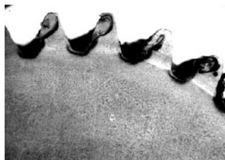
照片 3 流变齿顶的低倍组织
