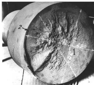
图2 劳特轧机上轧辊断口实照
